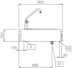
Scarico acqua ΕI Connessione elettrica Vite Equipotenziale EQ Ingresso acqua
